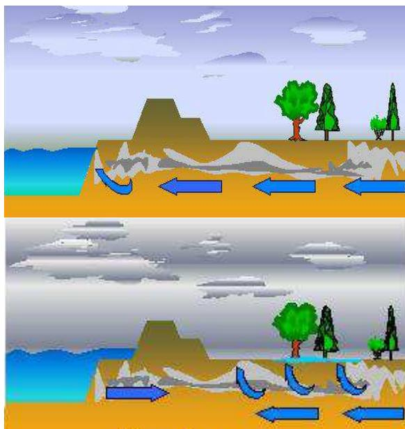
Questo non genera soltanto i fontanazzi in prossimità degli argini ma può creare buchi e anfratti nel sottosuolo e provocare cedimenti anche strutturali sia delle strade che delle case.
